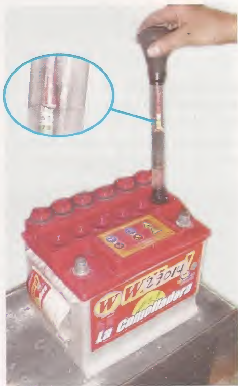
Medición de densidad de la batería
